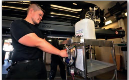
Menge Öl im Wärmetauscher zurück. Durch die Automatikgetriebe-Spülung wird somit gewährleistet, dass die gesamte Ölmenge und auch alle störenden Schmutzpartikel entfernt werden können!
