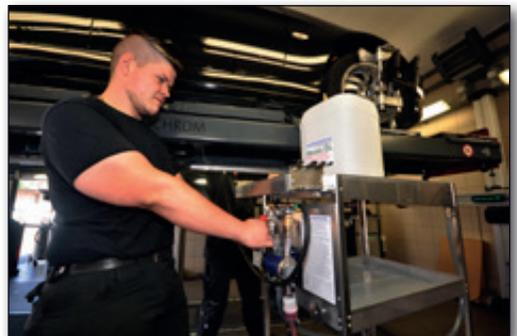
Durch die Automatikgetriebe-Spülung wird somit gewährleistet, dass die gesamte Ölmenge und auch alle störenden Schmutzpartikel entfernt werden können!
